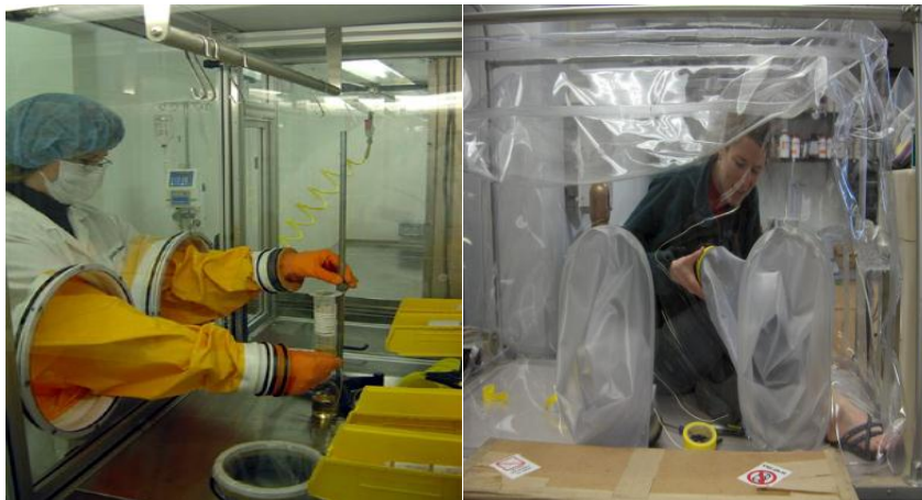
شکل ۶- راست: جعبه دستکش دار (Glove Box) - چپ: کیسه دستکش دار (Glove Bag)
