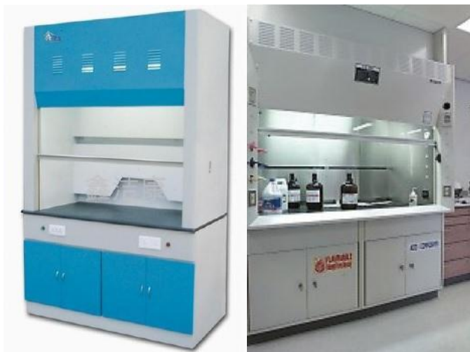
شکل ۲- نمونه‌هایی از محفظه‌های محصور برای کار ایمن با نانومواد
