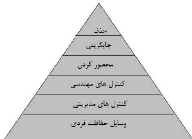
شکل ۱- اجرای روش های کنترل مواجهه با نانومواد
